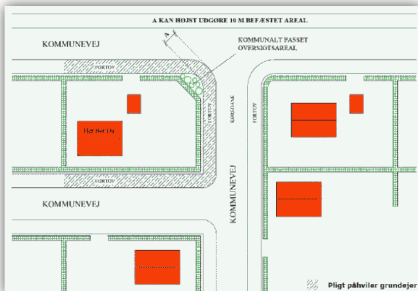
Figur 1. Hjørnegrund grænsende til 3 kommuneveje med fortov. Grundejer kan pålægges pligten på alle sider, da de ligger i ubrudt forlængelse af en adgang til ejendommen.
